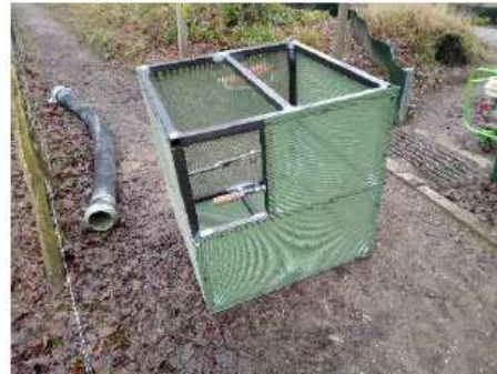
Afbeelding 3: Kooiconstructie gebruikt om te voorkomen dat vissen worden opgezogen.
